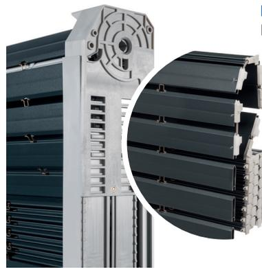
**Faltsystem.** Die Abwicklung des Regapak® Faltrölladens über die Mitnehmerwalze stellt die geordnete Ablage von zwei Stäben im Paket sicher. Es ist auch eine vertikal platzsparende Version erhältlich, die im Paket jeweils drei Stäbe ablegt und dadurch die benötigte Sturzhöhe verringert.
