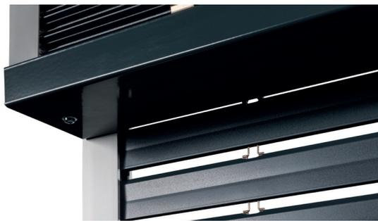
Untere **Abdeckung** für die Paketschale aus thermolackiertem Aluminium. Standardhöhe 40 mm. Bei Konstruktionsbreiten von über 2'000 mm wird eine verstärkte Abdeckung im Mass 100 mm geliefert.
