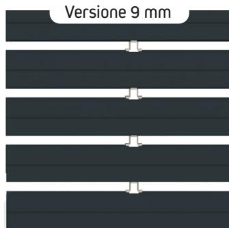
Le **stecche mobili** sono unite tra di loro con solidi ganci in acciaio al nickel-cromo. I ganci distanziano le stecche fino a 3mm (versione 3 mm) oppure fino a 9mm (versione 9 mm) con il telo in tensione, mentre offrono un oscuramento totale a telo chiuso.
