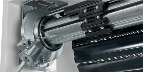
**Rullo d'avvolgimento** e supporti in acciaio zincato idonei per l'installazione immediata nella maggior parte dei fissaggi esistenti. L'avvolgimento del telo possibile sia verso l'esterno che verso l'interno. Sistema automatico di antisollevamento standard.
