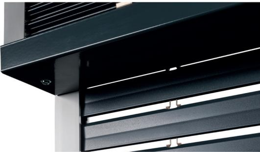
**Lamiera inferiore** di copertura del canale di raccoglimento del pacchetto in alluminio anodizzato o termolaccato. Altezza standard 40 mm. Oltre i 2'000 mm di larghezza luce, la lamiera viene fornita di 100 mm.
